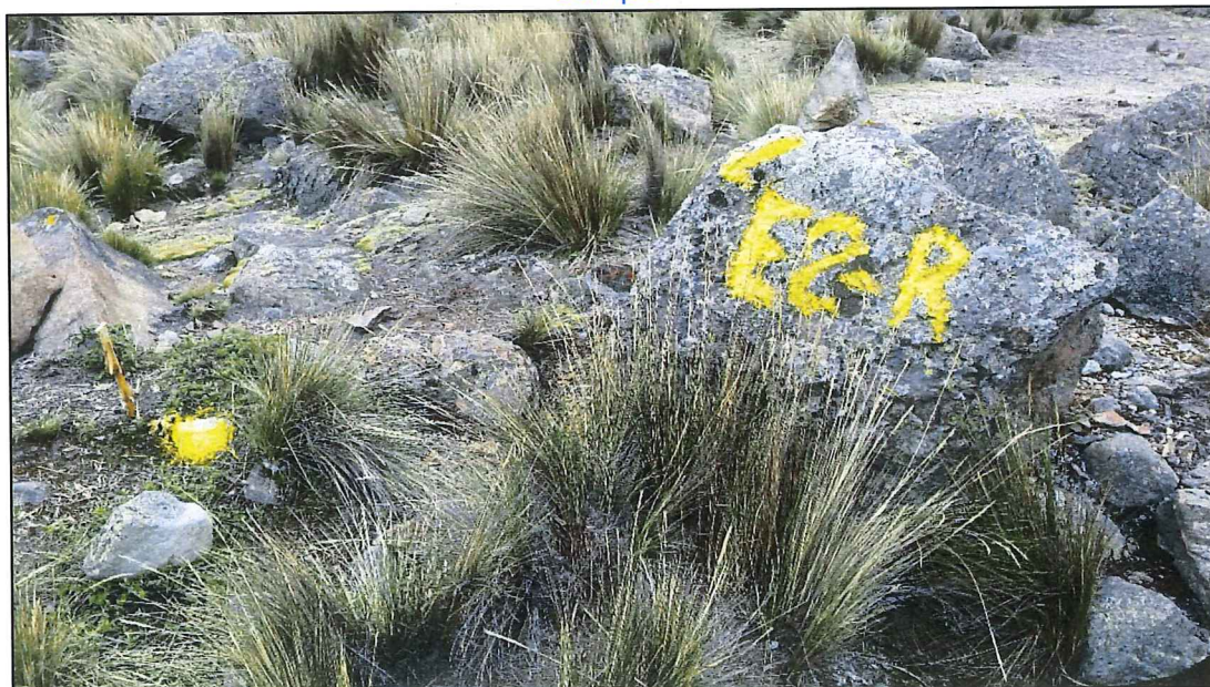
Foto N° 6.- Se observa el punto de control BM (E2-R), monumentado en campo
