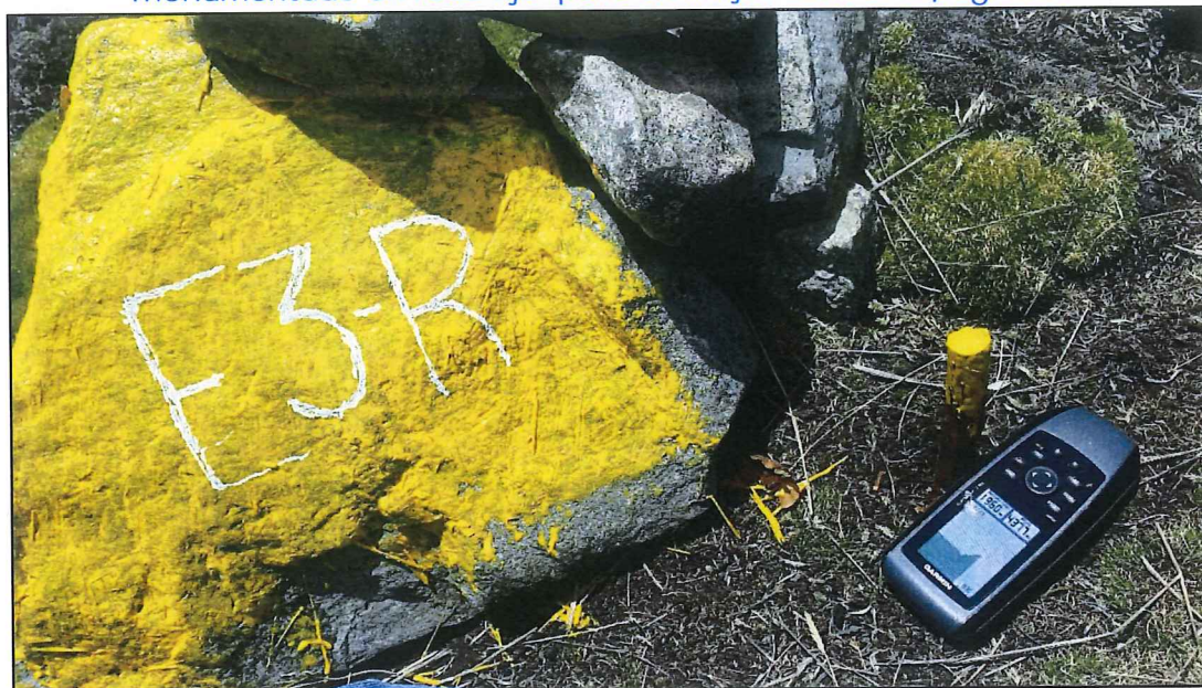
Foto N° 11.- En la fotografía se observa el punto de control BM (E3-R), monumentado en roca fija para un mejor control topográfico
